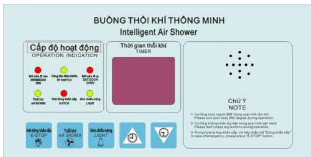
Sơ đồ của bảng điều khiển buồng tắm khí dạng ống kỹ thuật số / Diagram of the Digital Tube Air Shower Control Panel
